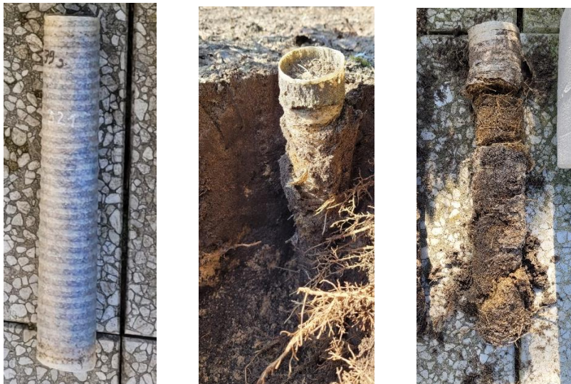
Abb. 1 Links: RWH 100% biobasiert, vor „Pflanzung“ 3,5 Monate mit feuchtem Sphagnum gefüllt und am 26.08.2023 in Erde ohne Schatten südseitig eingegraben. Mitte: RWH am 09-03-24 freigelegt. Rechts: RWH nach 6,5 Monaten am 09-03-24 vollständig ausgegraben.
