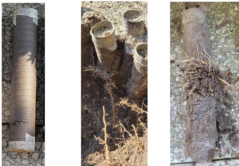
Abb. 1 Links: RWH 100% biobasiert, vor „Pflanzung“ 3,5 Monate mit feuchtem Sphagnum gefüllt und am 26.08.2023 in Erde ohne Schatten südseitig eingegraben. Mitte: RWH am 09-03-24 freigelegt. Rechts: RWH nach 6,5 Monaten am 09-03-24 vollständig ausgegraben.
